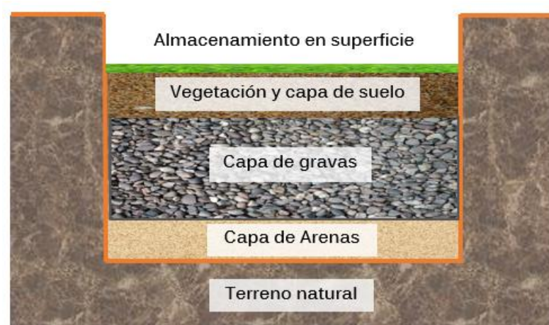
Figura 56: Ejemplo de SUDS con capas de diferentes materiales.
