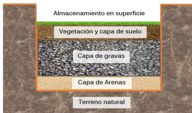
Figura 56: Ejemplo de SUDS con capas de diferentes materiales.
